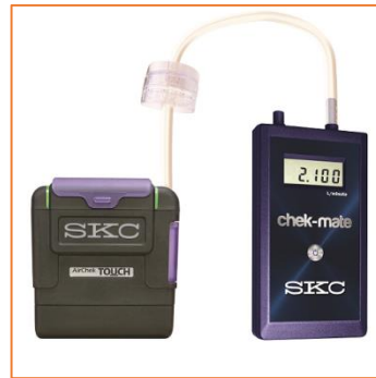
Calibration des pompes AirChek
