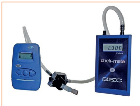
Calibration de la pompe AirChek 3000
